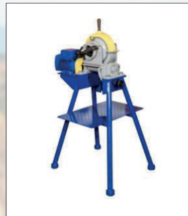
Шаровая мельница с объемом барабана 1 л
