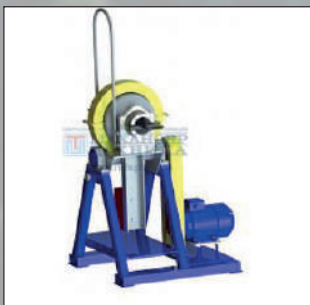
Шаровая мельница с объемом барабана 7 л
